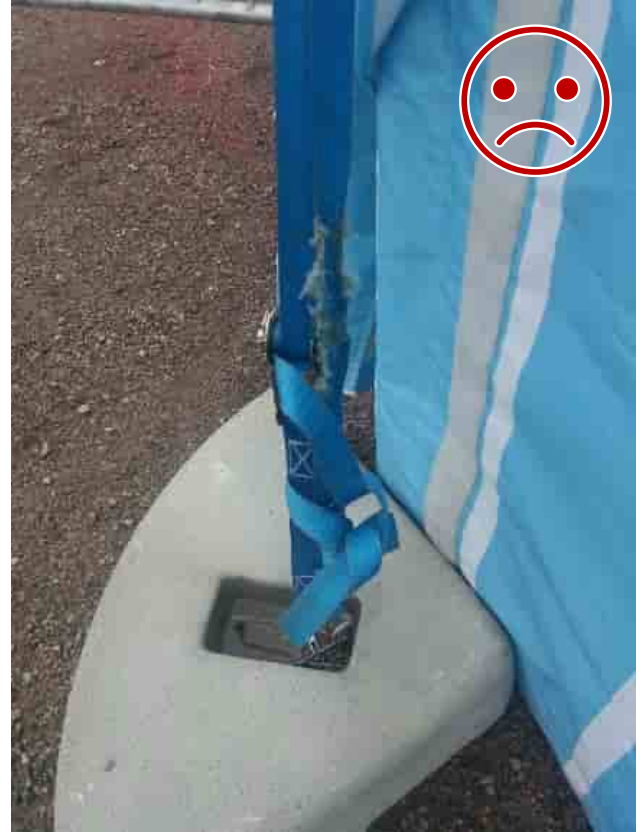
Kuva 10 EI NÄIN. Kuormaliina on kulunut.
