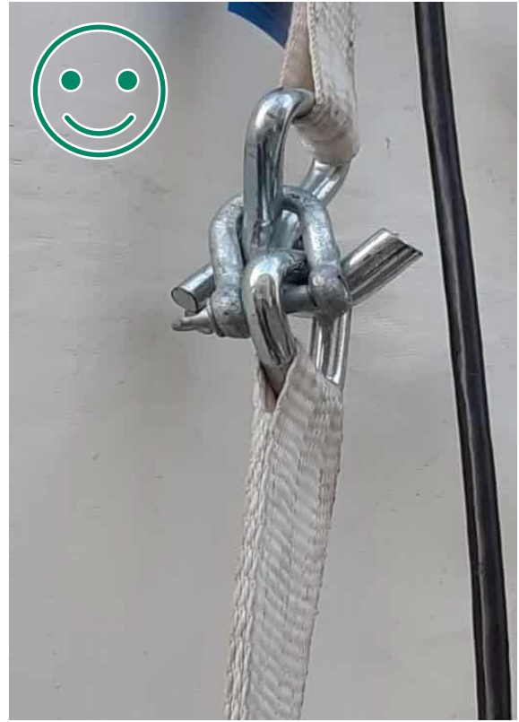
Bild 8 BRA PRAXIS. Krokarna låsta med schackel.
