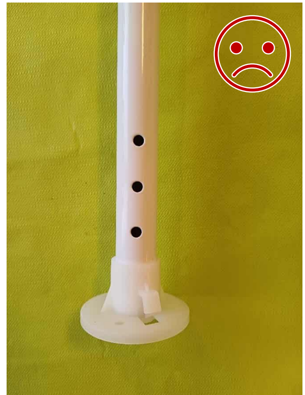
Bild 14 INTE SÅ HÄR. Konstruktion avsedd för konsumentbruk. Stödfoten av plast är inte låst vid stolpen och tål inte belastning.
