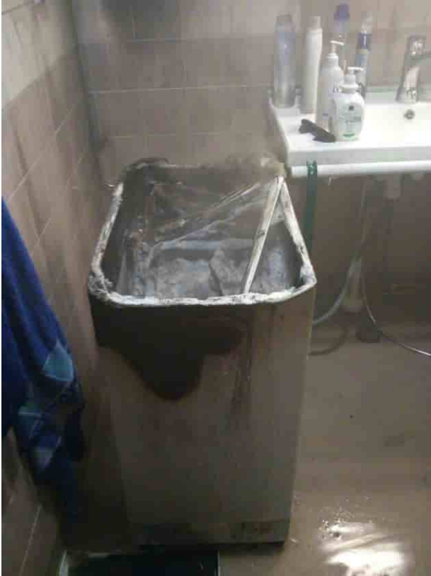
Tapaus 12: WC:ssä syttynyt pesukone palon jälkeen
